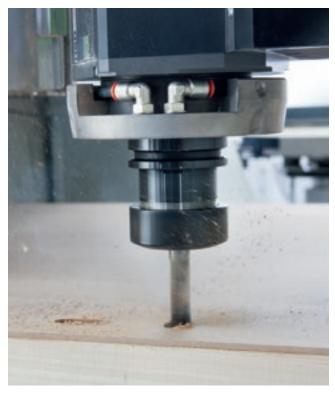
Rover K Smart è dotata di 3 o 4 assi indipendenti e interpolanti e può essere equipaggiata con aggregati in grado di eseguire tutte le lavorazioni sia su pannelli che elementi in massello.
